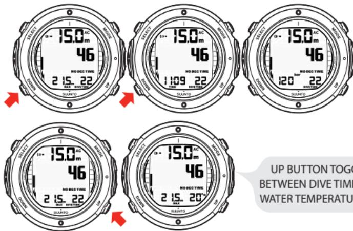
DOWN BUTTON TOGGLES BETWEEN MAXIMUM DEPTH, CURRENT TIME AND TANK PRESSURE.
